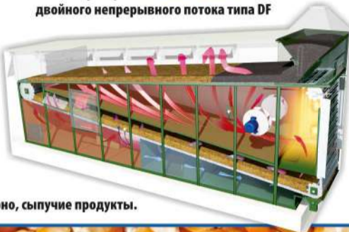
Зерносушилки Alvan Blanch двойного непрерывного потока типа DF
